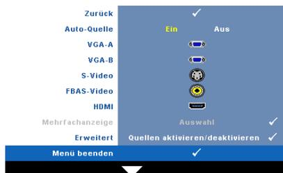
**AUTO-QUELLE**—Wählen Sie **Aus** (Standardauswahl), um das aktuelle Eingangssignal zu speichern. Wenn Sie die **Quelle**-Taste betätigen, während **Auto-Quelle** auf **Aus** eingestellt ist, können Sie das Eingangssignal manuell auswählen. Wählen Sie **Ein** zur automatischen Erkennung verfügbarer
