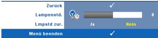
**LAMPENSTD.**—Hier werden die Betriebsstunden seit dem Zurücksetzen des Lampen-Timers angezeigt.
