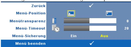
**MENÜ-POSITION**—Ermöglicht das Ändern der Position des Bildschirmmenüs auf dem Bildschirm.
